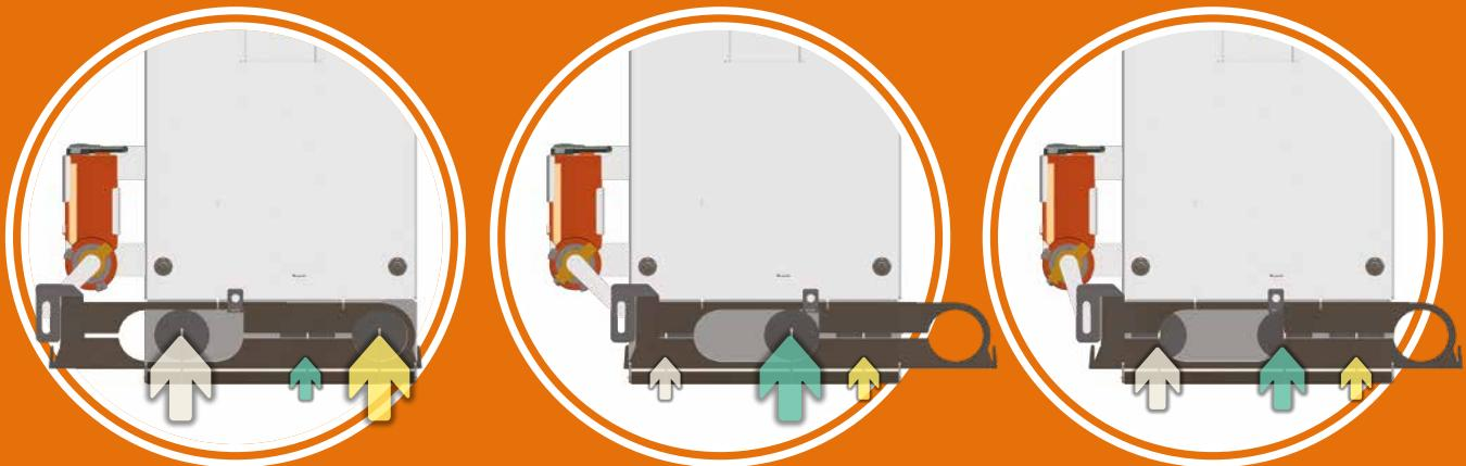
**L'air de préséchage et l'air primaire sont ouverts à 100 %**, l'air secondaire est complètement fermé. C'est la position du diaphragme d'arrivée d'air en cas d'utilisation d'un combustible humide ou de grosses bûches.
