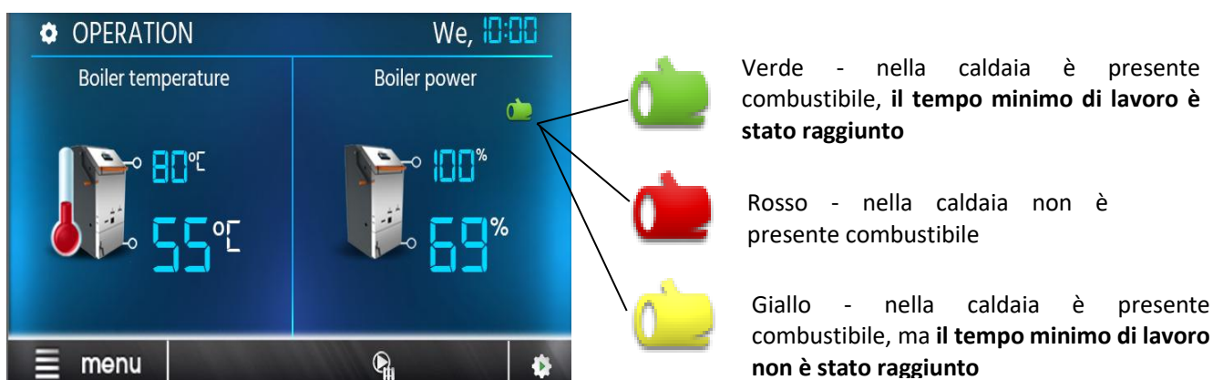
Figura 5. Visualizzazione a colori della segnalazione di combustibile
