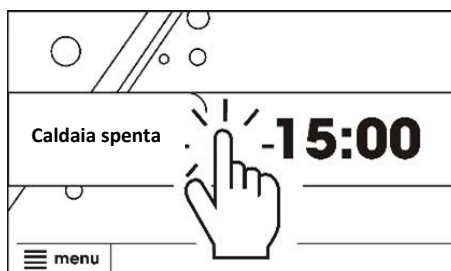
Figura 2. Accensione della caldaia
