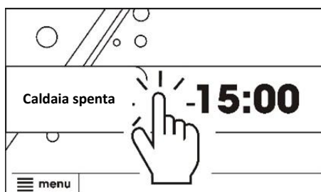
Figura 2. Accensione della caldaia
