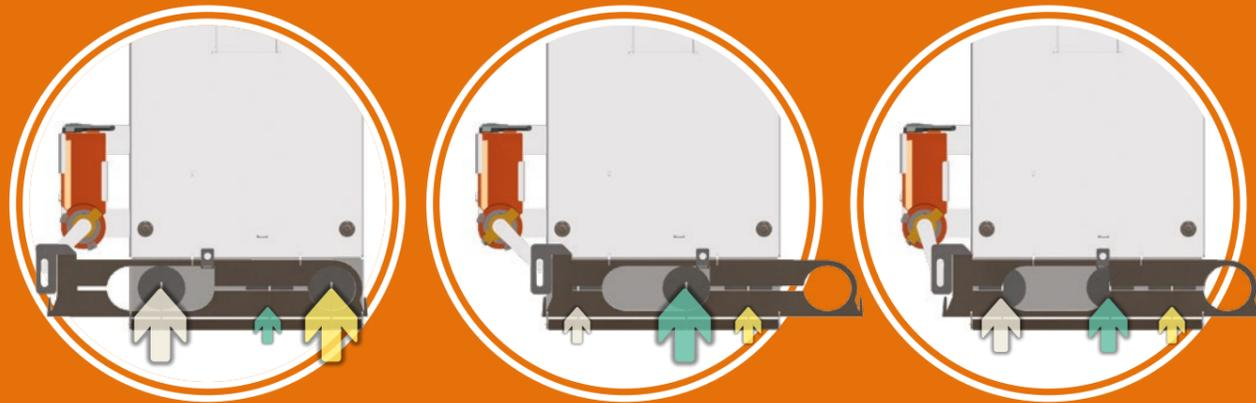
**El aire de pre-secado y el aire primario abiertos al 100 %**, el aire secundario está completamente cerrado. En esta posición se encuentra la apertura de entrada del aire cuando se quema el combustible húmedo o grandes leños.
