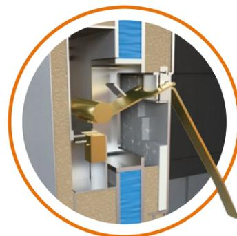
**Sonda lambda + servo-accionamiento** garantizan óptimos parámetros de combustión (proporción de oxígeno en gases de combustión)
