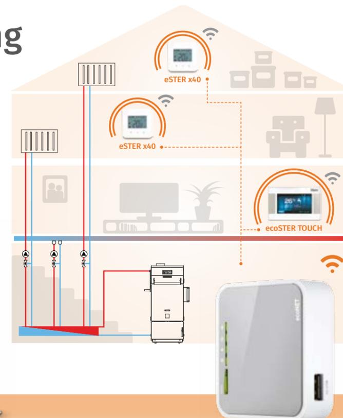
Das Internetsystem ecoNET ermöglicht dem Benutzer Fernzugriff auf Verwaltung und Monitoring des Kessels und Heizungssystems. Dank diesem System kann der Benutzer die eingestellten Parameter des Kessels und des Heizungssystems ändern, aber auch die Betriebsgeschichte des Kessels und des Heizungssystems ablesen, die in einem übersichtlichen Graph dargestellt wird.
